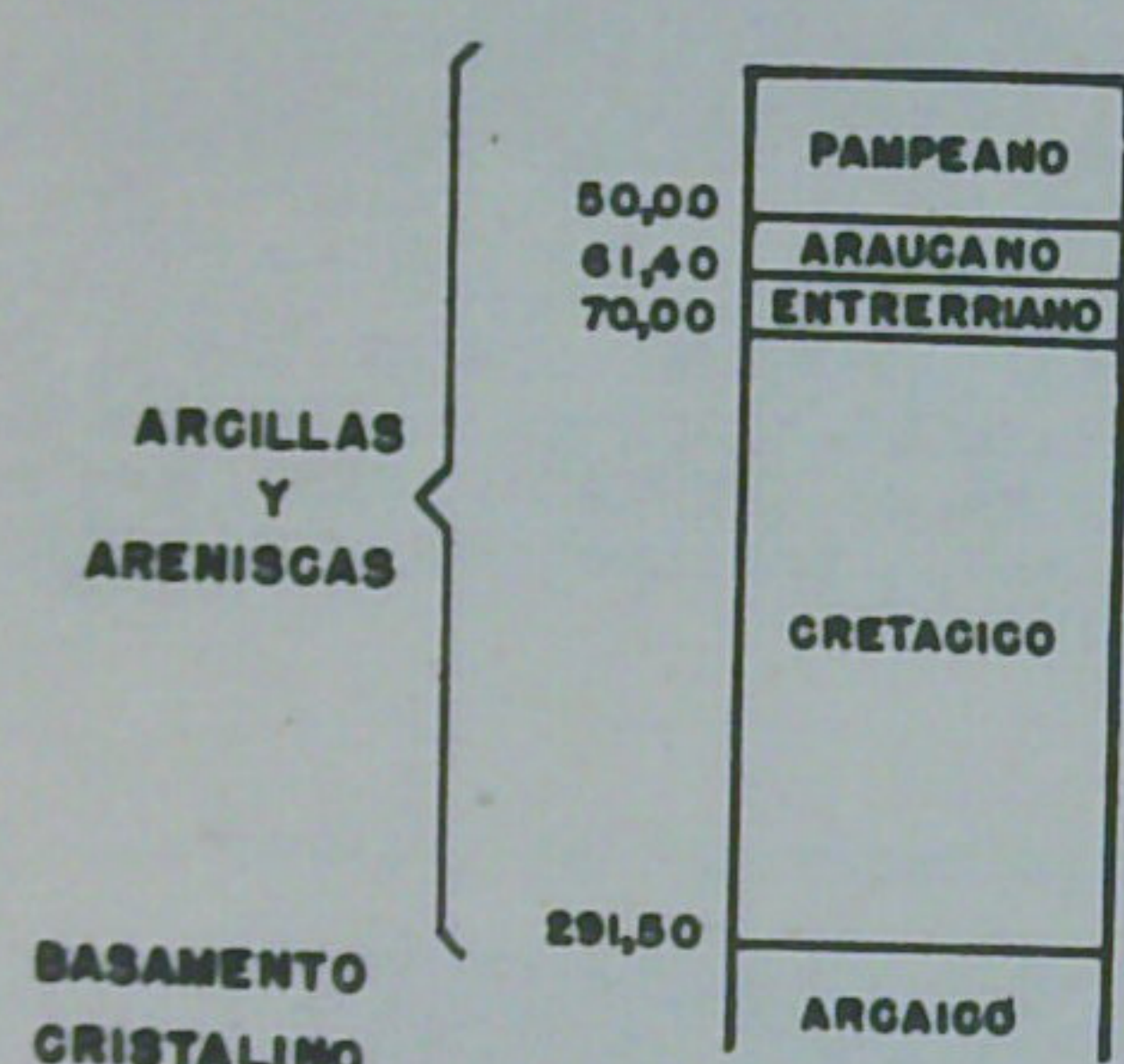
Fig. 1.- PERFIL GEOLOGICO (según J.J.Núñez)
